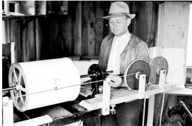
Figure 2: “Eugene Cecil LaFond [circa 1938] standing by his wave recorder installed near the end of the Scripps pier.” ( Eugene Cecil LaFond [vers 1938] se tenant à côté de son enregistreur de vagues, installé à proximité de l’extrémité de la jetée de Scripps ) Eugene LaFond Papers, 1937-1939, BOX 18, FOLDER 16, Scripps Institution of Oceanography Archives.
